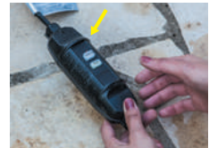
4. Drücken Sie die Reset-Taste, die Anzeige leuchtet auf. Der FI-Stecker ist einsatzbereit.
